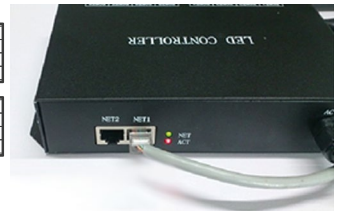
Рис. 2. Подключение контроллера HX-801RC к мастер-контроллеру или компьютеру.
