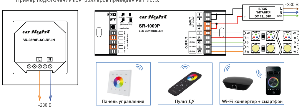
Рис. 3. Схема подключения оборудования на примере контроллера SR-1009P.
