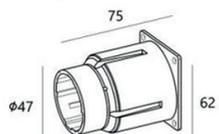
4. Установите светильник в закладную деталь. (Рисунок 3.)
