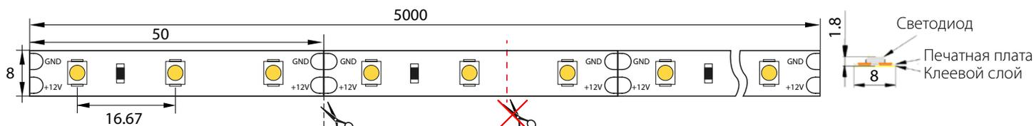
Ленту можно резать только в обозначенных местах, между контактными площадками для пайки.
