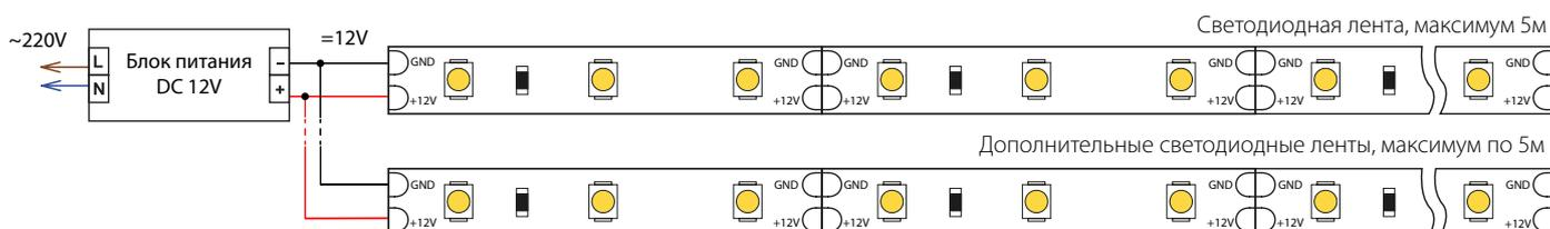
1. Питание ленты осуществляется постоянным стабилизированным напряжением 12V. Блок питания должен иметь запас по мощности не менее 20%. Для 5-ти метров ленты рекомендуется БП мощностью не менее 29 Вт, например арт. 018968, арт. 012919.
